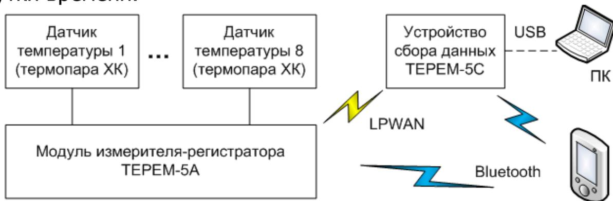
Рисунок 1 - Структурная схема внешних связей устройств системы контроля
