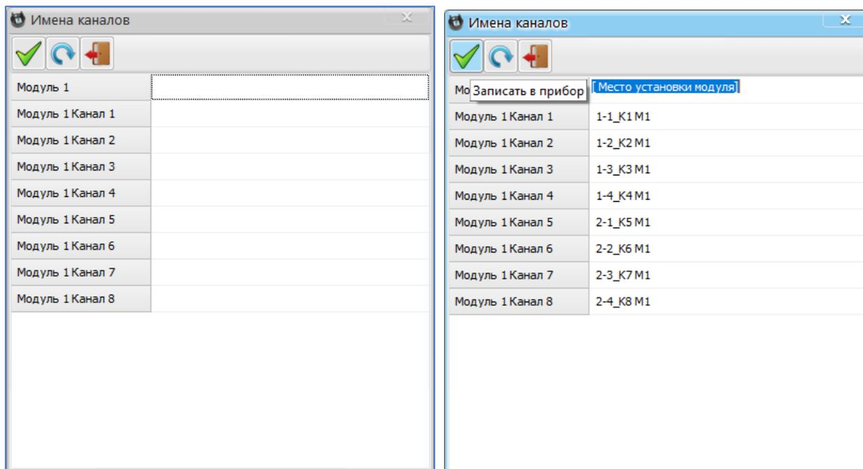
Данное описание после его ввода записывается в УСД и при первом же соединении УСД со смартфоном, записывается в соответствующее поле управляющего приложения на смартфоне.
