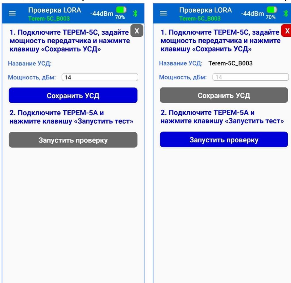
Рисунок 19 – Экран меню «Проверка LORA», подготовка к проверке
